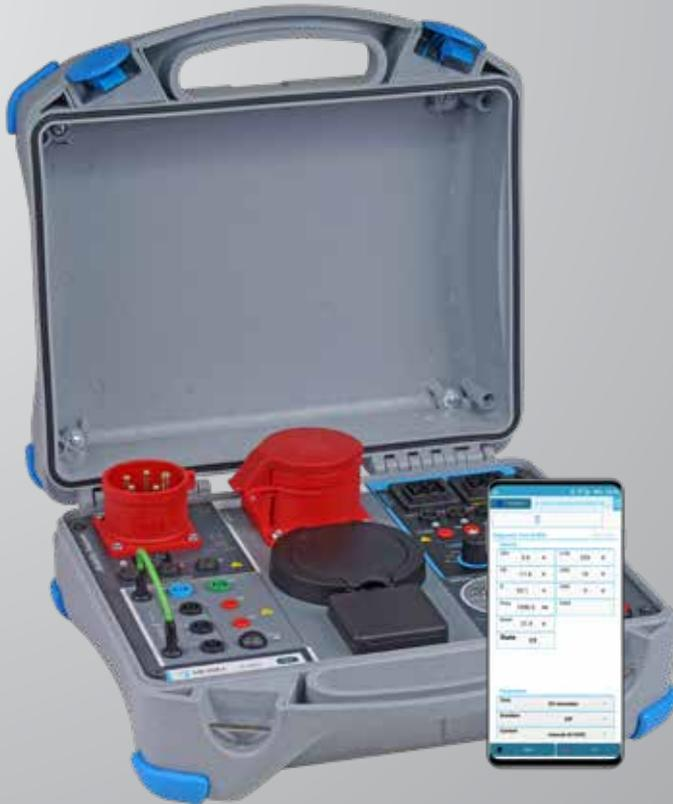
Der A 1632 eMobility Analyser ist ein Diagnoseadapter für die Überprüfung von Ladestationen (EVSE) und deren Zubehör. Er arbeitet mit den Metrel Installationstestern zusammen und unterstützt die Überprüfung der elektrischen Sicherheit sowie der Funktionsprüfung. Typ 2 Ladesäulen, Mode 2 (ICCB) / Mode 3 Ladekabel (EV) und die Überwachung der Kommunikation während der Ladung können überprüft werden. In dem Metrel ES Manager erfolgt nach dem Speichern der Ergebnisse die Berichtserstellung.
