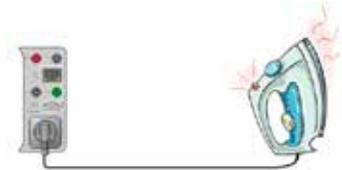
Prüfung des PE-Leiter-Ableitstroms für Geräte der Klasse I
