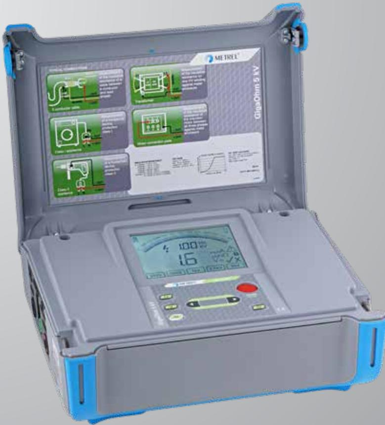
Das MI 3202 GigaOhm 5 kV bietet eine schnelle und genaue Prüfung des Isolationswiderstands. Fünf Prüfspannungen bis 5 kV und 1 T $\Omega$  Widerstandsmessbereich decken den größten Teil der Verwendung im Industrie- und Stromverteilungsbereich ab. Die große analoge/digitale LCD-Anzeige mit Hintergrundbeleuchtung sorgt für ein leichtes Ablesen der Prüfergebnisse. Das Messgerät wird in einem robusten Tragekoffer untergebracht, der einen Einsatz in widrigen Bedingungen ermöglicht.
