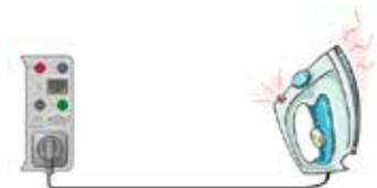
Prüfung des Differenzableitstroms für Geräte der Klasse I
