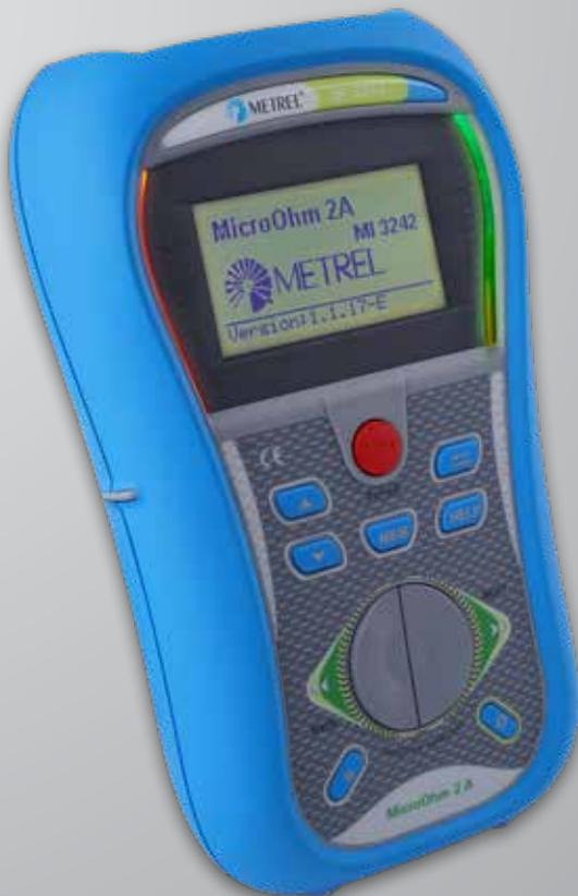
Das MI 3242 MicroOhm 2A ist ein tragbares Widerstandsmessgerät zum Messen der geringen Widerstände von Schaltern, Relais, Verbindern, Sammelschienen, Kabelverbindungen von Stromverteilern, Motor- und Generatorwicklungen, Netztransformatoren, Speicherdrosseln, Gleisverbindern, Drähten und Kabeln, Schweißverbindungen für industrielle Anwendung usw. mit Prüfströmen bis 2 A.
