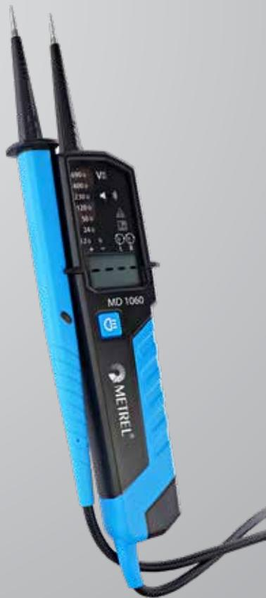
Die zweipoligen Spannungsprüfer werden gebaut und geprüft nach IEC/EN 61243-3:2014/VDE 0682. Die Spannungsanzeige erfolgt über helle LEDs, die in Bereiche von 12 - 690 V aufgeteilt sind, sowie zusätzlich als realer Effektivwert von 12 - 690 V in der LCD-Anzeige. Beide Modelle bieten Spannungsmessung, Durchgangsprüfung, einpolige Phasenprüfung sowie eine Drehfeldprüfung.
