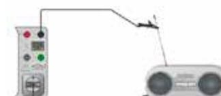
Ersatzableitstromprüfung für Geräte der Klasse II
