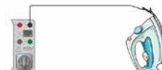
Ersatzableitstromprüfung für Geräte der Klasse I
