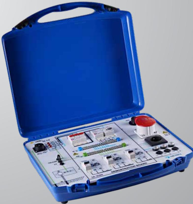
Das Demonstrations-Board MI 3099 simuliert mit wichtigen Elementen auf der Schalttafel und am Schaltungs-Standort, typische elektrische Installationen, die in der Regel in einzelnen Häusern oder Wohnungen anzutreffen sind. Das Demonstrations-Board ist vorzugsweise vorgesehen für den Einsatz durch das Verkaufspersonal, wenn der Betrieb von Elektroinstallationstestgeräten gezeigt wird, vor allem die neuen Sicherheitstester für elektrische Installationen mit integriertem AUTOSEQUENCE-Verfahren.
