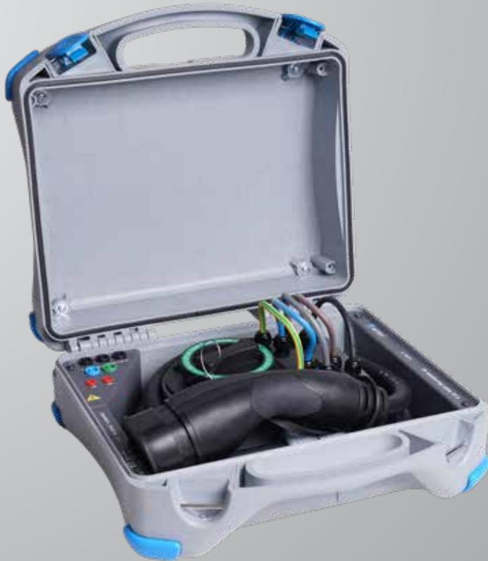
Das EV-Überwachungskabel A 1631 ist ein spezielles Zubehör, das für die CP-Signal-, Strom- und Spannungsüberwachung während des Ladevorgangs von Elektrofahrzeugen (EV) in Verbindung mit unterstützten Metrel-Testern und -Adaptoren entwickelt wurde. Es ist mit einer Typ-2-Buchse zum Anschluss an ein EV und einer Typ-2-Steckdose zum Anschluss an elektrische Fahrzeugversorgungsanlagen (EVSE) ausgestattet.
