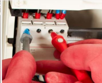
**Prüfspitze mit Testtaste**
