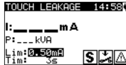
Abbildung 6.39: Startfenster für den Berührungsableitstrom
