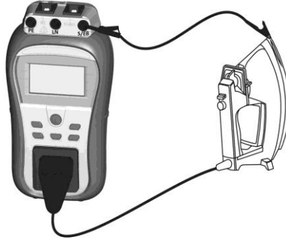
Abbildung 5.5: Messen des Erdungsdurchgangs
