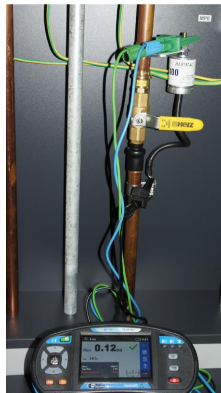
Abbildung 2-39: Isolationswiderstandsmessung am Varistor
