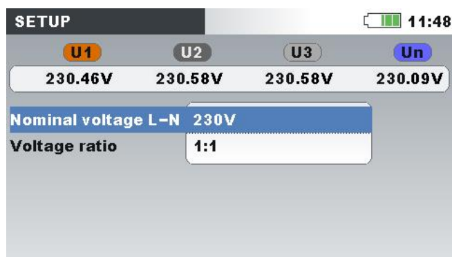
Abbildung 3-4: Einstellung der Nennspannung am Prüfgerät
