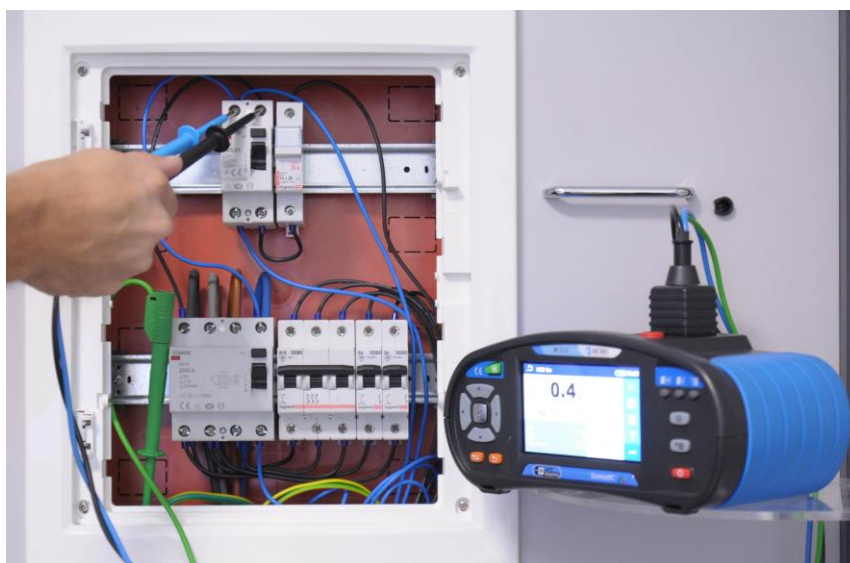
Abbildung 2-11: Schaubild für die Messung der Fehlerschleifenimpedanz - TT-System
