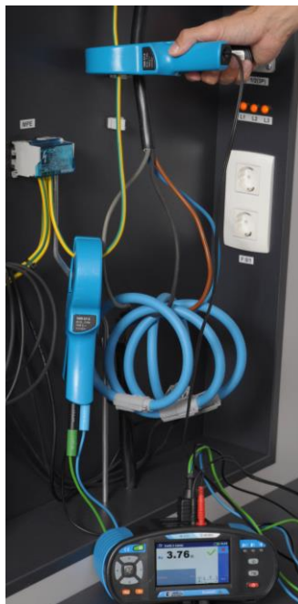
Abbildung 2-48: Erdungswiderstandsmessung mit der 3-Leiter-Methode
