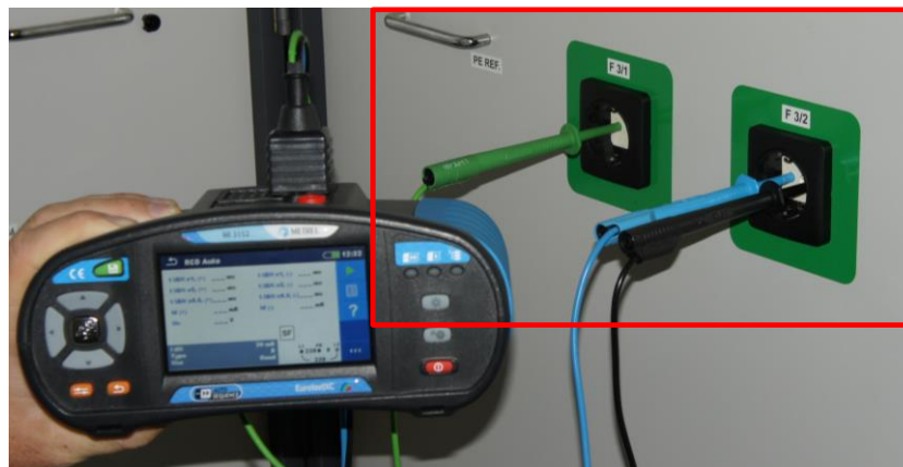
Abbildung 2-26: RCD Messung in einem IT Erdungssystem
