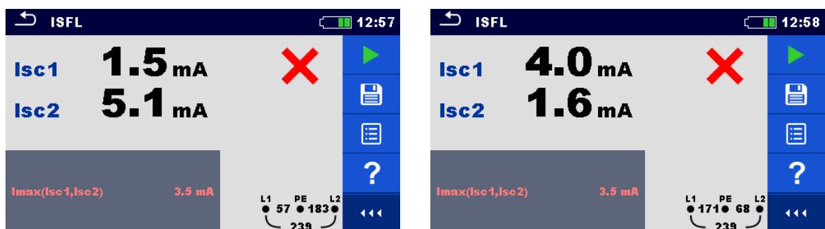
Abbildung 2-30: ISFL simuliert Fehler in einem IT System
