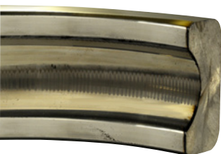
Geriffelte Oberfläche an einem Lauftring, verursacht durch Lagerströme (Foto mit freundlicher Genehmigung von Electro Static Technology).
