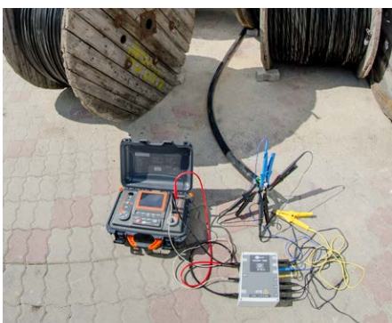
Mehradrige Messungen durch ein nur einmaliges anschließen
