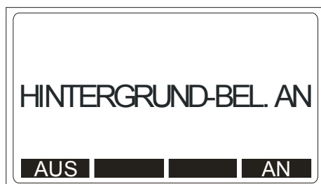
Bild 20: LC-Anzeige Menü "HINTERGRUND-BELEUCHTUNG"
