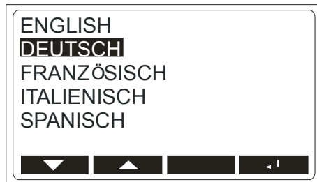
Bild 18: LC-Anzeige Menü "SPRACHE"
