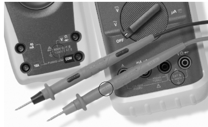
Sehen Sie sich die Kategorie und die Spannungsspezifikation der Messleitungen und des Multimeters an.
