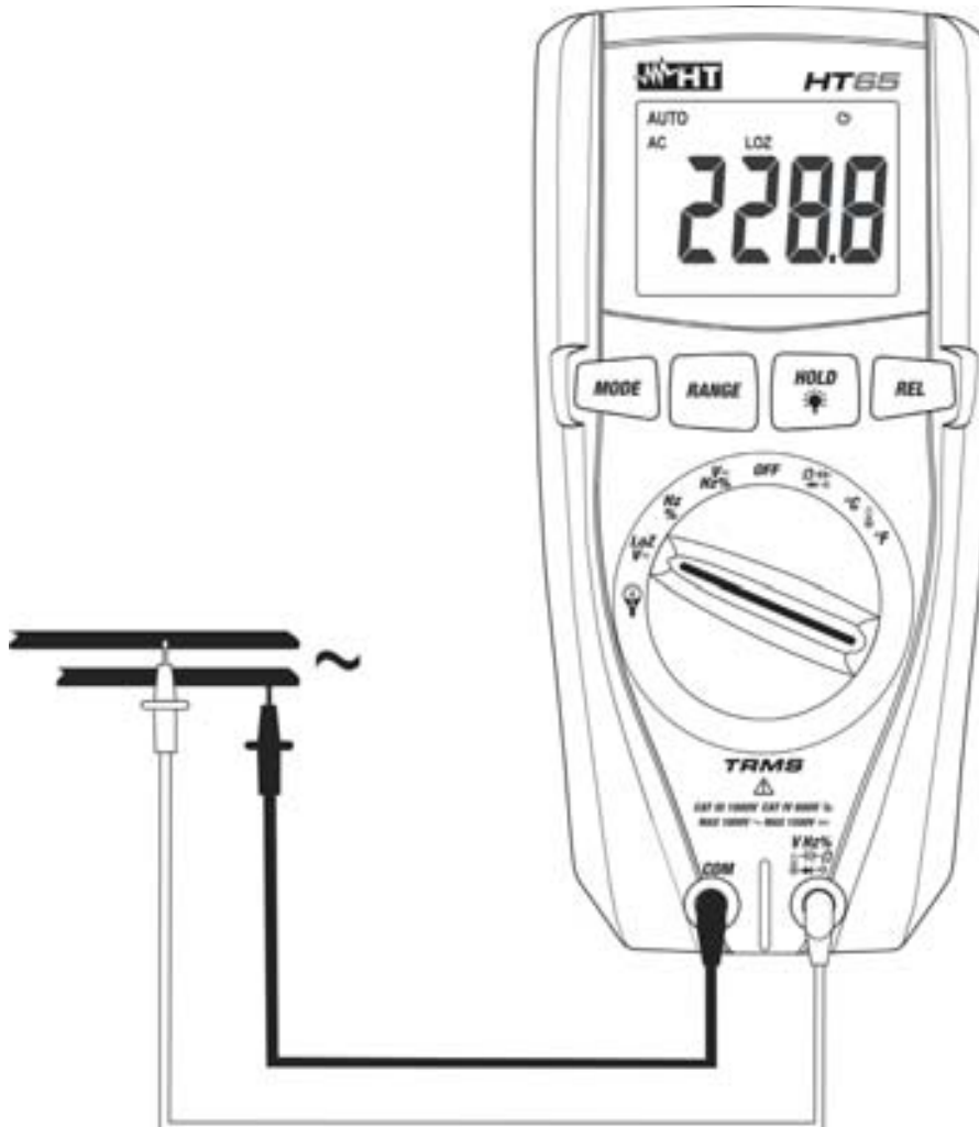
Abb. 4: Verwendung des Gerätes für Spannungsmessung mit niedriger Impedanz (LoZ)
