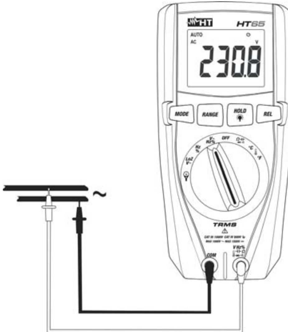
Abb. 3: Verwendung des Gerätes für AC Spannungsmessung
