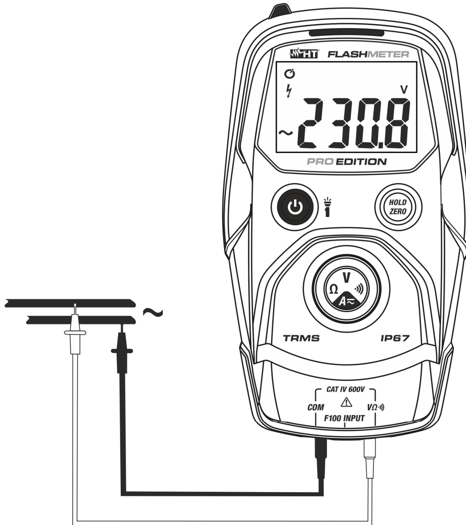
Fig. 4: Uso dello strumento per misura di Tensione AC
