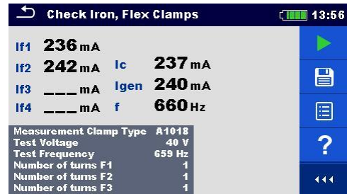
Abbildung 11.108: Beispiel Stromzangen, flexible Stromzangen - Prüfung Ergebnis
