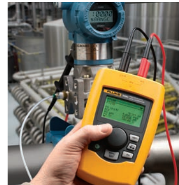
Fluke-Stromschleifenkalibratoren sind zuverlässig und genau. Der 709H ist zusätzlich mit Basisfunktionen für die HART-Kommunikation ausgestattet (siehe Seite 16).
