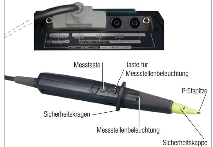
Die Prüfspitze mit integrierter Bedieneinheit ermöglicht Ihnen eine Fernauslösung an schwer zugänglichen Stellen oder solchen, die Ihre ganze Aufmerksamkeit erfordern. Schlecht ausgeleuchtete Messstellen können über die integrierte Prüfspitzenbeleuchtung aufgehellt werden. Gegen Störeinflüsse ist die Anschlussleitung geschirmt.
