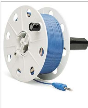
50 m Messleitung, aufgewickelt auf eine Metalltrommel. Der Anschluss an das eine Ende der Messleitung ist über eine in die Trommel integrierte Buchse möglich. Das andere Ende ist mit einem Bananenstecker ausgerüstet. Die Trommelachse mit Griff ist steckbar, sodass die Trommel platz sparend aufbewahrt werden kann. Der Widerstandsanteil des Kabels kann in der Schalterstellung  $R_{LO}$  kompensiert werden.
