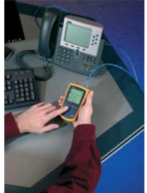
dem sich nahezu alle Kabel oder Aderpaare unabhängig vom Einsatzumfeld exakt orten lassen. Im digitalen Modus können hochwertige Datenkabel (Cat 5e, 6, 6a) in Kabelbündeln oder an Switches, Patchfeldern oder Wanddosen geortet werden. Der Analogmodus eignet sich für Telefonkabel (Cat3 und niedriger) sowie für Koax-, Sicherheits-/Alarm- und Lautsprecherkabel.
