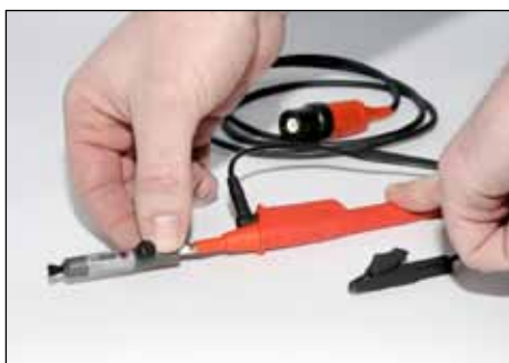
5. AEGIS® SVP-Messspitze über die Oszilloskop-Messspitze schieben
