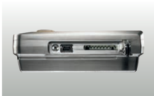
Seitlicher Anschluss von Mini-USB-Kabel und SD-Karte
