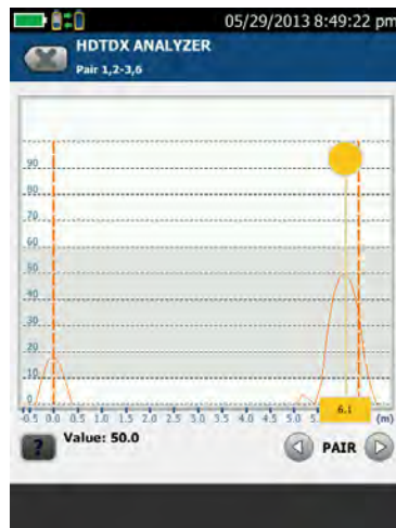
High Definition Time Domain Crosstalk (HTDTX) zeigt eindeutig, dass das ferne Verbindungsende das Problem darstellt.
