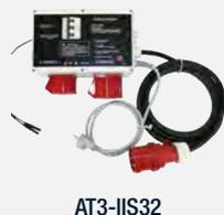
**Adapter zur aktiven und passiven Prüfung von Drehstromverbrauchern in Verbindung mit Sicherheitstestern der Reihe SECUTEST**
