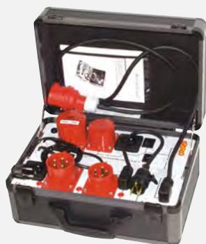
**Adapter zur aktiven und passiven Prüfung von Drehstromverbrauchern und Verlängerungsleitungen in Verbindung mit Sicherheitstestern**
