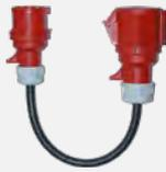
Adapterkabel CEE 16 A 5-pol-Stecker rot auf CEE 32 A 5-pol-Kupplung rot, 0,5 m, 5x1,5 mm<sup>2</sup>
