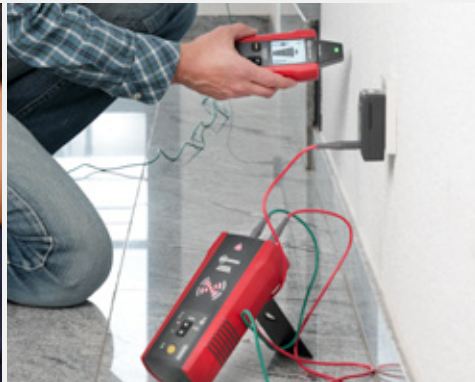
Suche von spannungsführenden und spannungsfreien Adern/Leitungen
