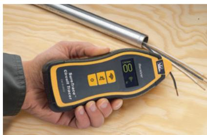
Einzelne Drähte können sortiert, offene Adern und Kurzschlüsse können einfach lokalisiert werden.
