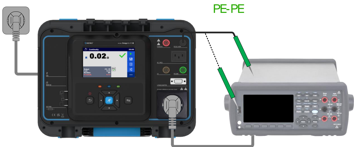
Abbildung 100_Durchgang der Schutzterde
