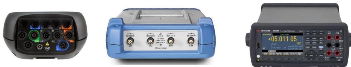
Abbildung 96_Typische Geräte mit potentialfreien Eingängen
