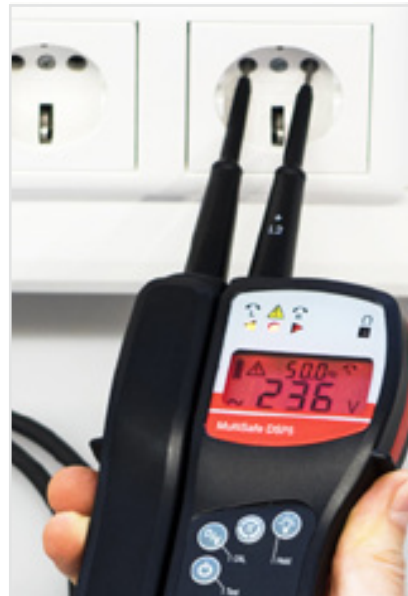
Einhandbedienung zur Prüfung von Steckdosen
