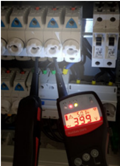
Messstellenbeleuchtung und beleuchtete LCD für dunkle Umgebungen
