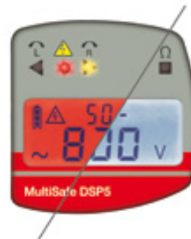
Farbwechsel der Anzeige bei gefährlicher Spannung
