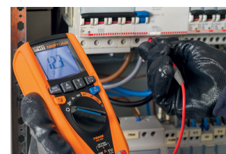
Drehfeldrichtung mit 1-phasiger Methode.
