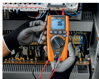
LoZ Funktion eliminiert Streuspannungen
