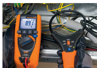
Messung des Stroms mit flexiblem Wandler.
