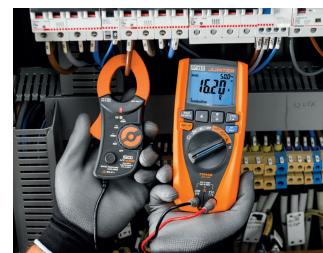
AC+DC Strommessung TRMS.
