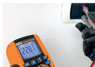
LoZ Funktion eliminiert Streuspannungen.
