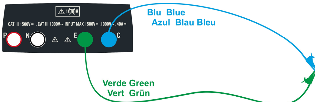
Abb. 5: Kompensation des Widerstands der Messkabel
